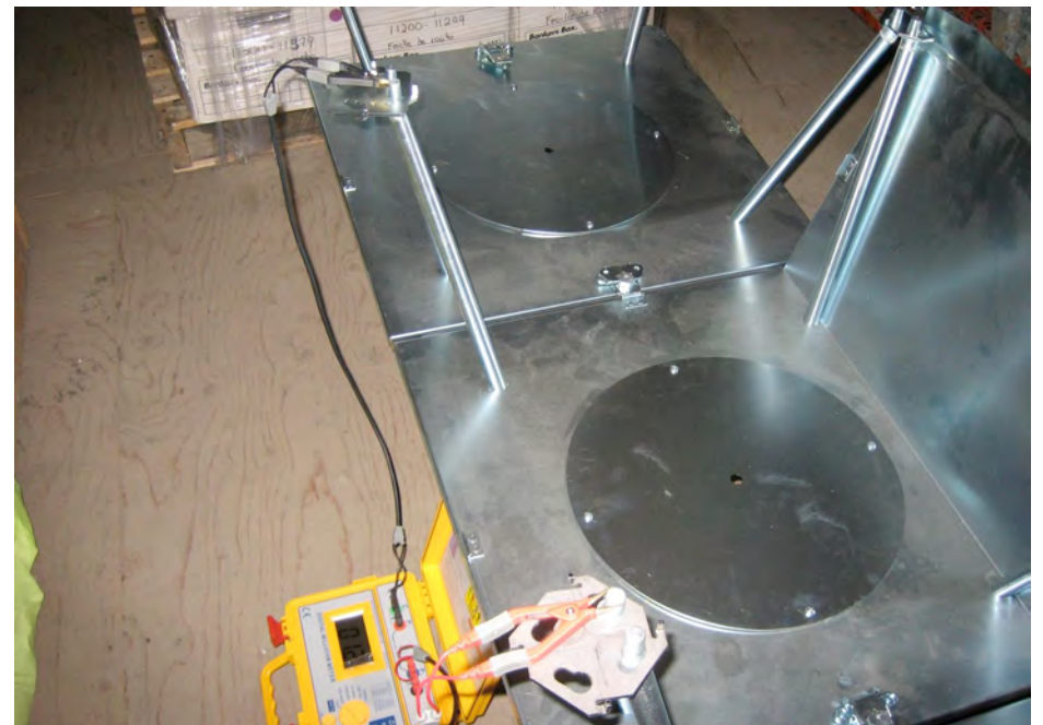
Pic. 12- Top Panel Lug Module 2 to Top Panel Lug Module 2- Reading 1.3 mOhm
